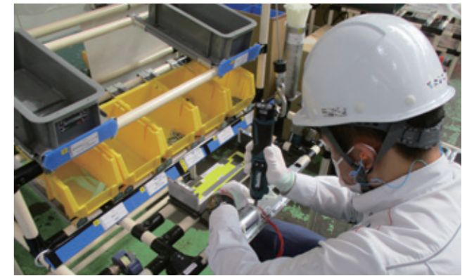
電動ドライバーを用い、電気部品を取り付ける部品組み立て作業
