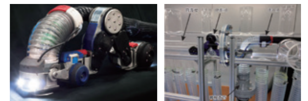
小型走行型水管厚さ連続測定ロボットとラボ試験装置
